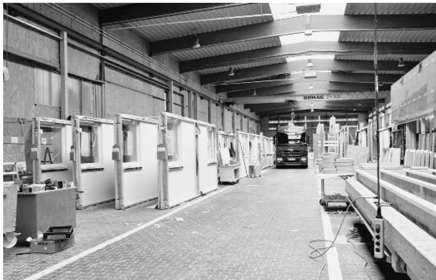
Diese Fassadenelemente werden in Neuenkirchen bei der Firma Brüggemann komplett mit integrierter Dämmung, Fenstern und Außenputz gefertigt. Foto: Brüggemann
